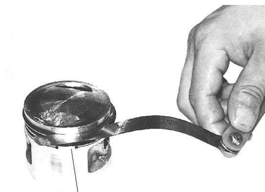
piston ring groove
